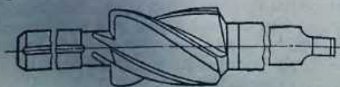
Рис. 103. Зенкер для торцовки и снятия нагара в колодце под форсунку в моноблоке
