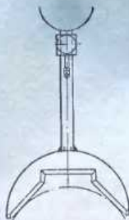
Рис. 72. Призма с индикатором для проверки радиуса кривошипа вала
